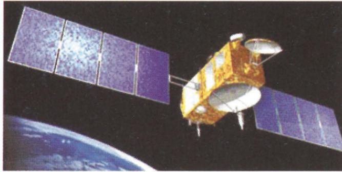
*Le satellite franco-américain JASON-1 qui fonctionne au dessus de l'océan en mesurant continûment par radar son altitude au dessus de la surface de l'eau avec une précision de l'ordre du centimètre.*
