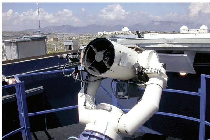
Ci-dessus, TAROT est un télescope entièrement automatisé capable de pointer vers n'importe quel point du ciel en moins de 5 secondes.
